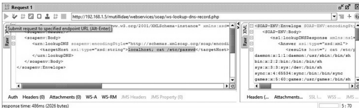
Figura 8.8 – A injeção de comandos do SOAP é similar à injeção de comandos feita em requisições HTTP.
